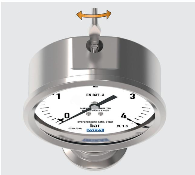
Подстройка нуля может выполняться с помощью плоской отвертки после удаления герметизирующей заглушки сверху корпуса..
